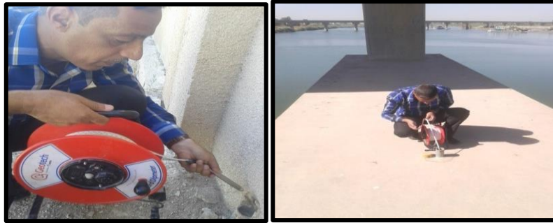
شكل (3): يبين طريقة قياس منسوب البيزومتر بجهاز الجيوستيك.
