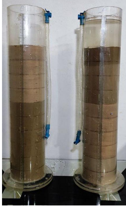
الشكل 5: الاسطوانات الشفافة المستخدمة في التجارب المختبرية (Al-Ogaidi et al., 2023).
